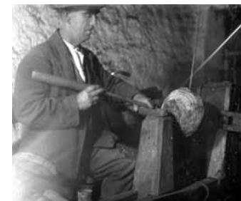
Thomas Loftus, hijo de James Loftus, Borrisokane, condado de Tipperary usando el torno de pedal y pértiga flexible de su padre.
